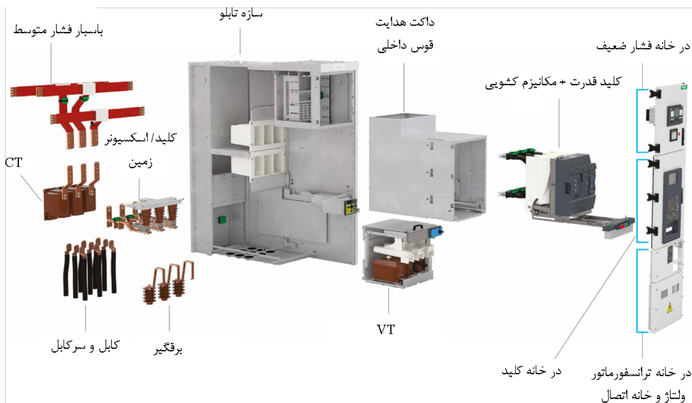
شکل ۷-۱۴- اجزا تابلو فشار متوسط نمونه
