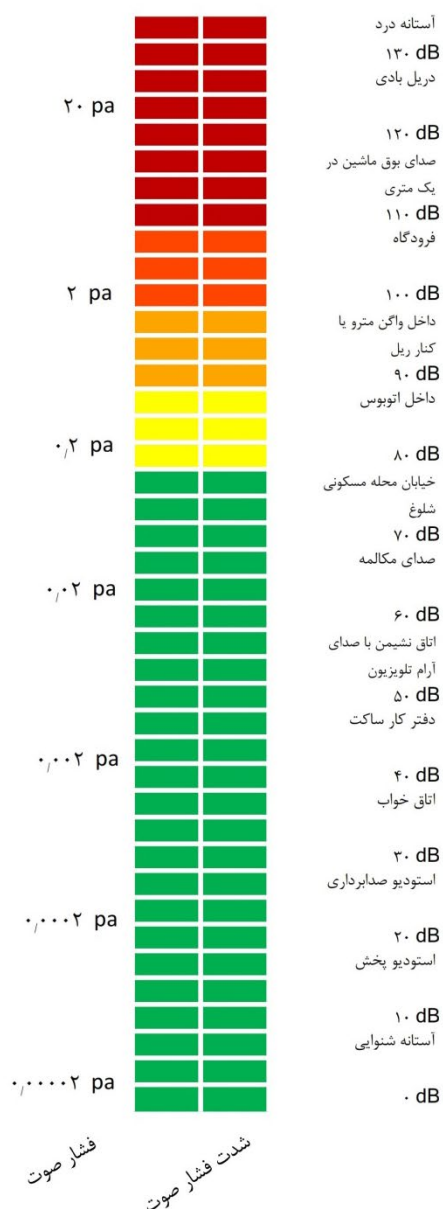
شکل ۷-۵- شدت فشارهای صوت مختلف بر حسب پاسکال و dB
